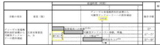
図 2.14.6 可搬型代替電源車による非常用高圧母線（6-A）及び非常用高圧母線（6-B）受電のタイムチャート*
