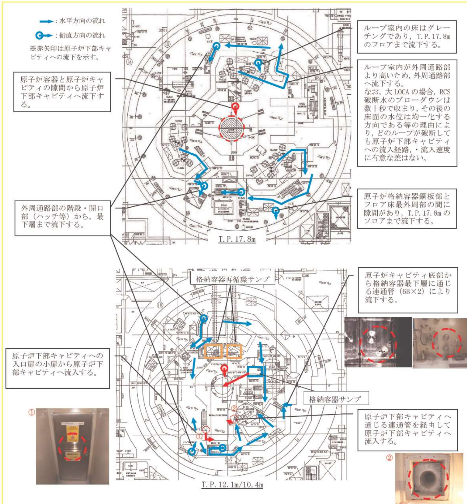
図2 スpray水及びRCS破断水の原子炉下部キャビティへの流入経路 (T.P. 17.8m, T.P. 12.1m/10.4m 平面図)
