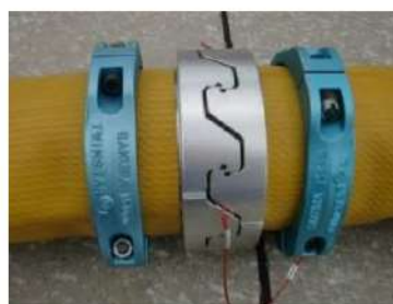
可搬型ホース(150A)接続後
