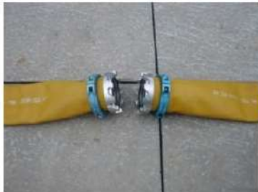
可搬型ホース（150A）接続前
