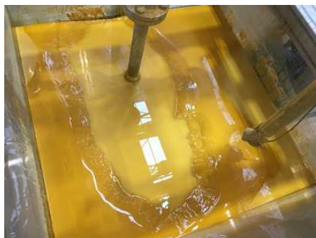
図. エダクタによるスラッジ吸引状況
