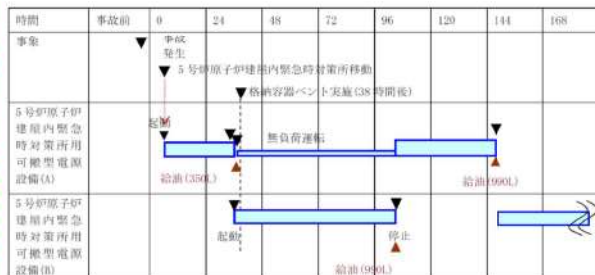
参考図 8.1-1 5号炉原子炉建屋内緊急時対策所用可搬型電源設備の給油時間
