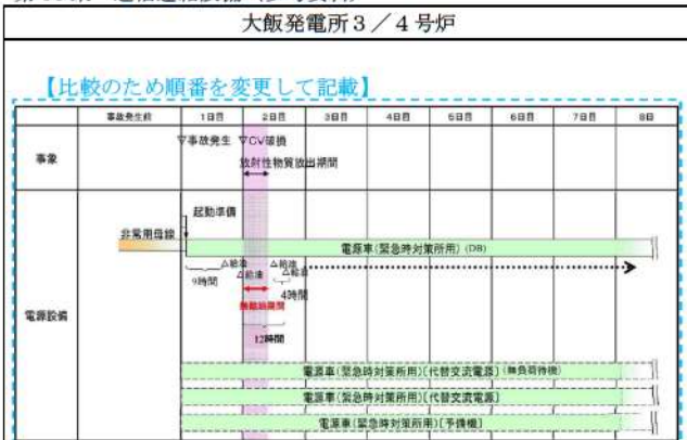
図9 電源車の給油が必要となるタイムチャート
