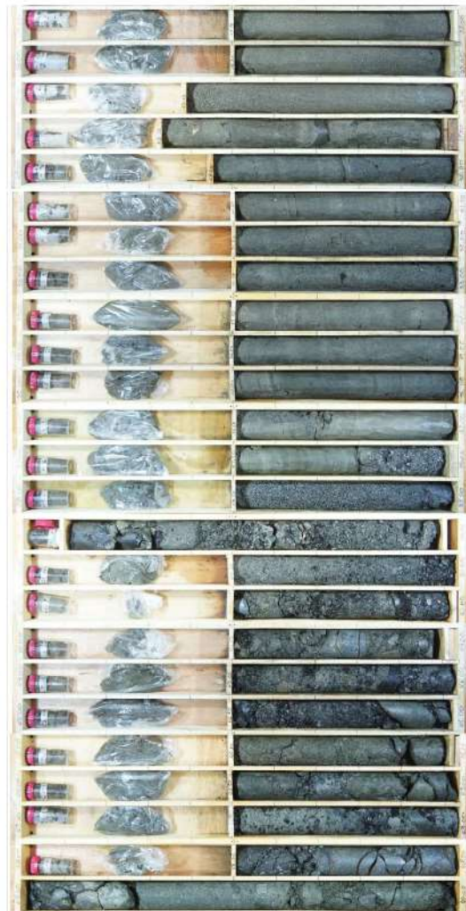
添付 1-61 図(2/3) ボーリング柱状図・コア写真 (SW3-2)
