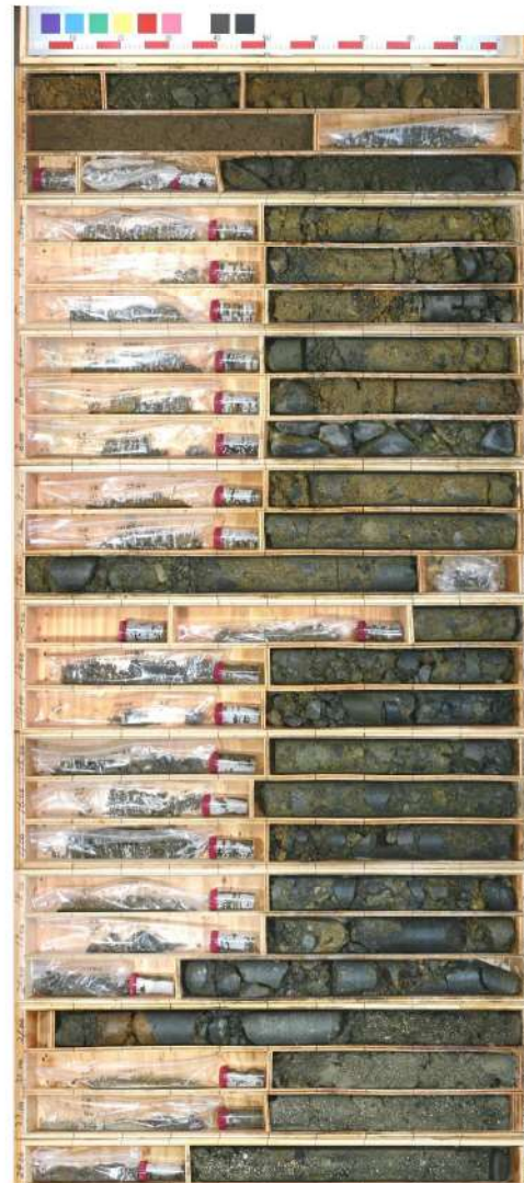
添付 1-41 図(1/3) ボーリング柱状図・コア写真 (U-1)
