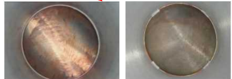
③・④の例：検査孔からのホットレグ内管の外観確認結果
