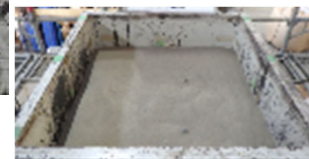
角型容器への砂充填試験例
