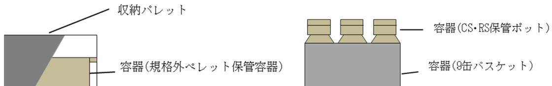
第3-5図 収納パレット及び容器(規格外ペレット保管容器, CS・RS保管ポット及び9缶バスケット)の概略
