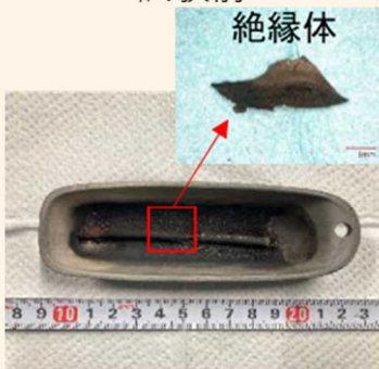
試験後 (1000°C水素ガス環境下)
