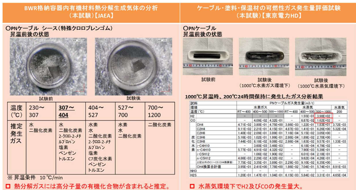
図 28-4 PNケーブルの結果概要
