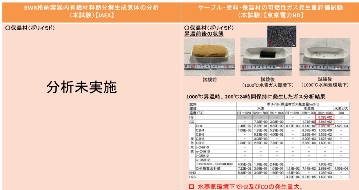
図 30-4 保温材の結果概要
