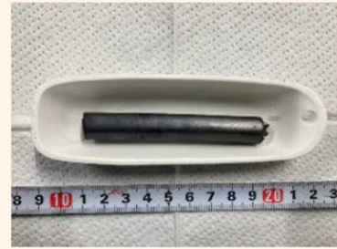
試験後 (200°C水蒸気環境下)
