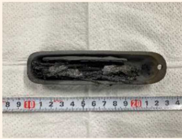
試験後 (1000°C水素ガス環境下)
