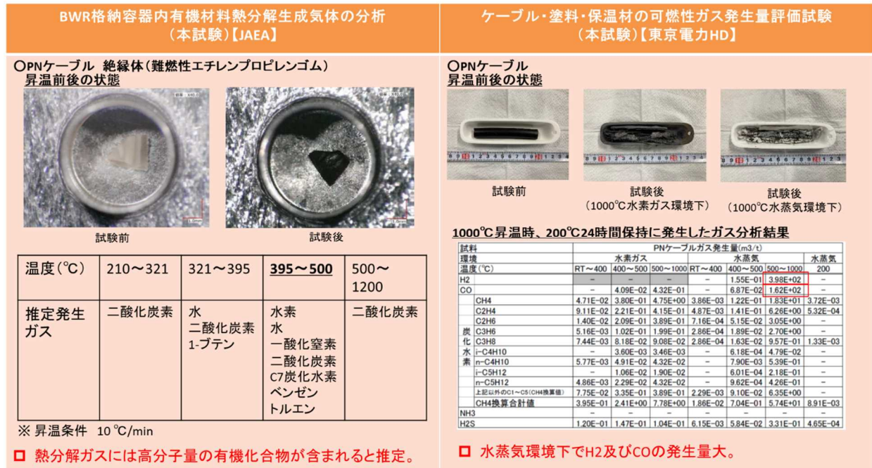
図 28-3 PNケーブルの結果概要
