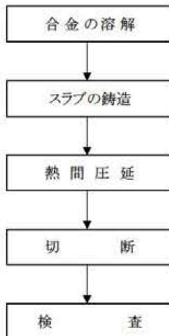
別紙 1-3 図 HZ-A3004 の製造プロセス
