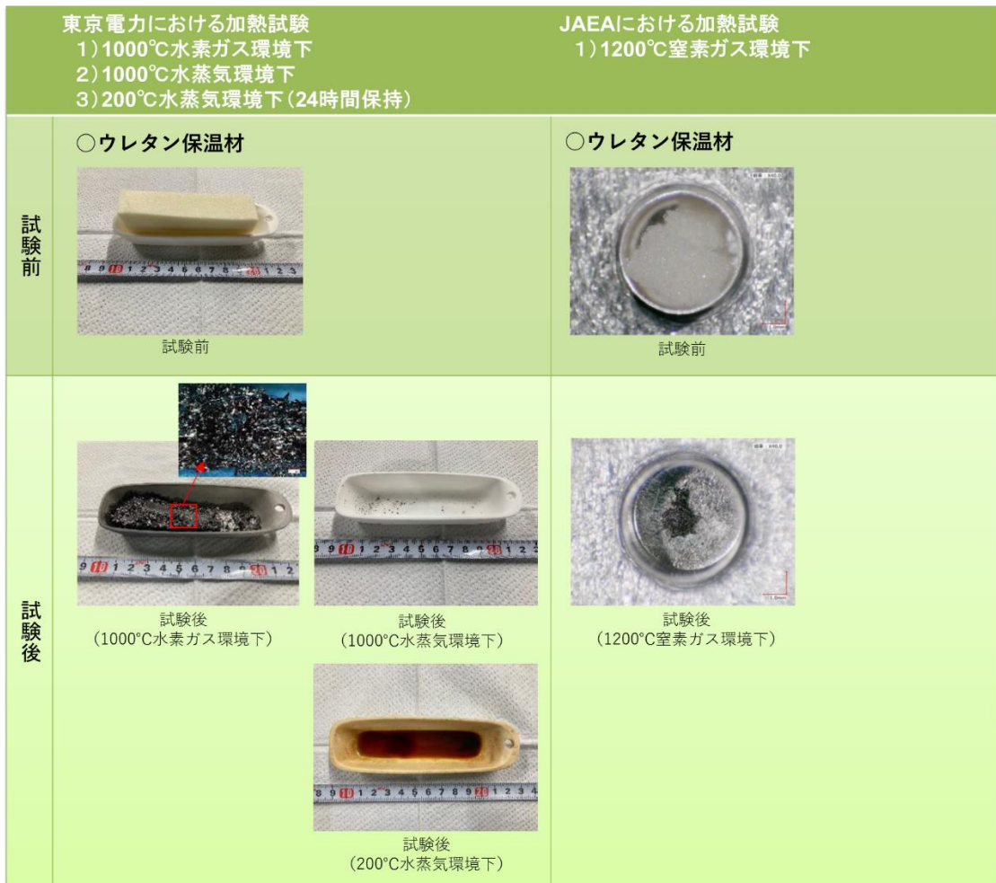
図8-1-1 東京電力及び JAEA における加熱試験（ウレタン保温材の例）
