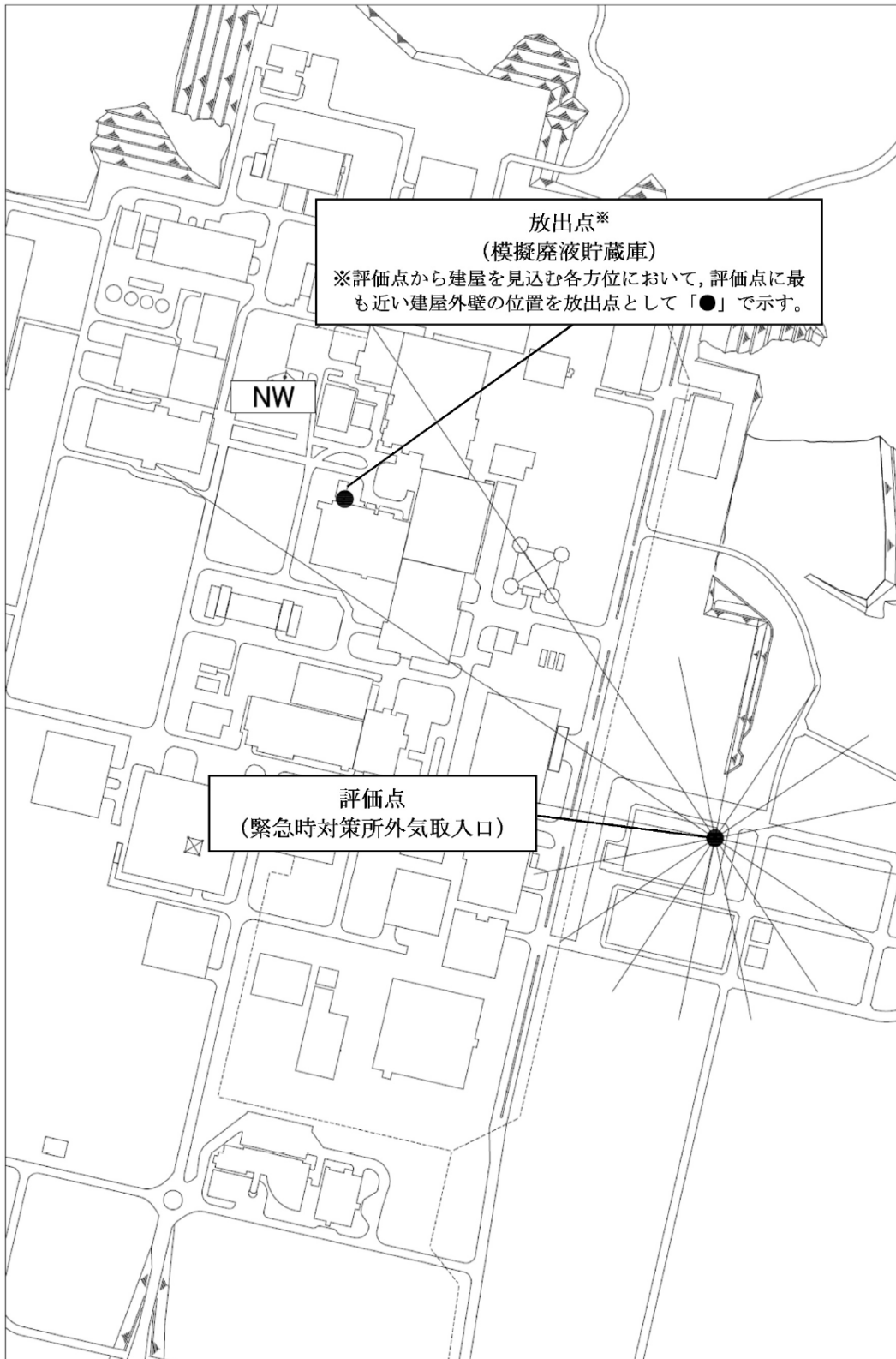
第 4. 2. 2-10 図 緊急時対策所の居住性に係る有毒ガス濃度評価における緊急時対策建屋の外気取入口と模擬廃液貯蔵庫との位置関係
