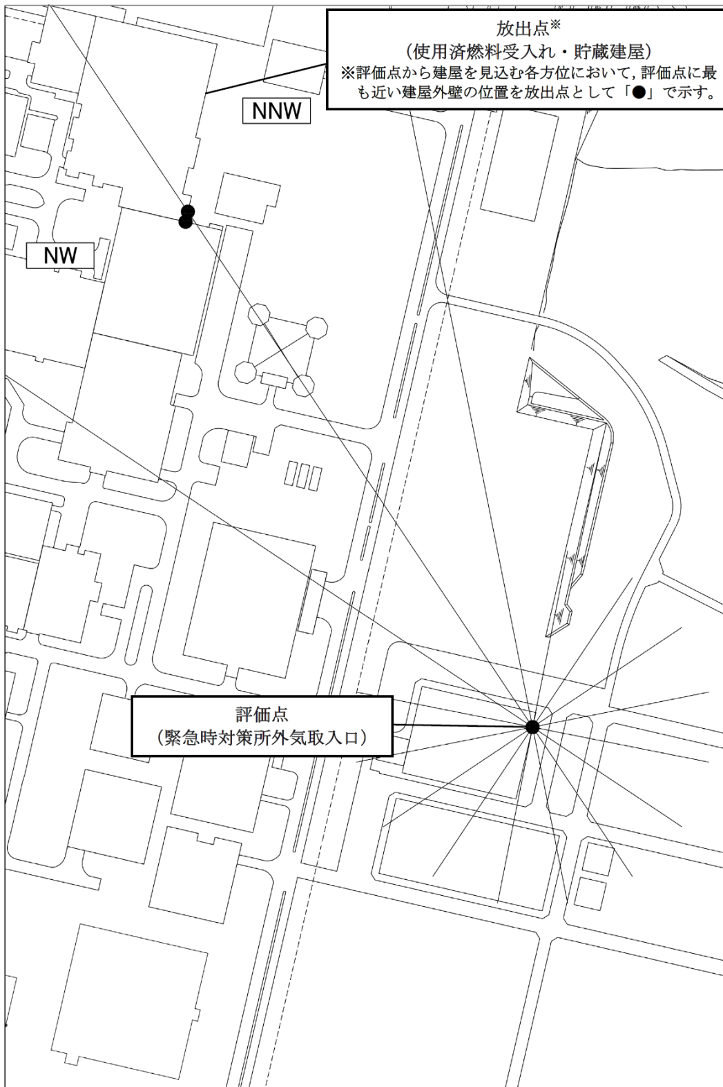
第 4.2.2-9 図 緊急時対策所の居住性に係る有毒ガス濃度評価における緊急時対策建屋の外気取入口と使用済燃料受入れ・貯蔵建屋との位置関係
