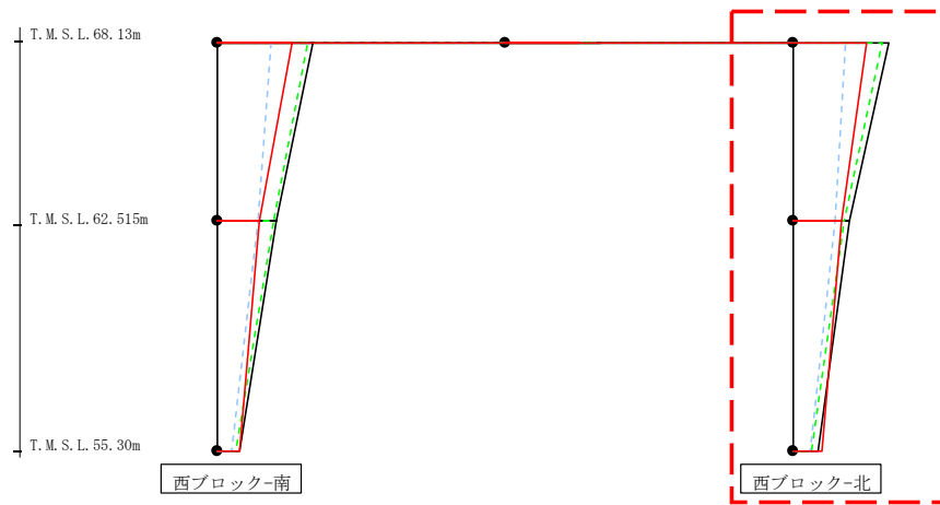
第4.2.2-49図 支持架構の最大応答加速度 (+1σ地盤, NS断面①, 有効応力解析) (2/2)
