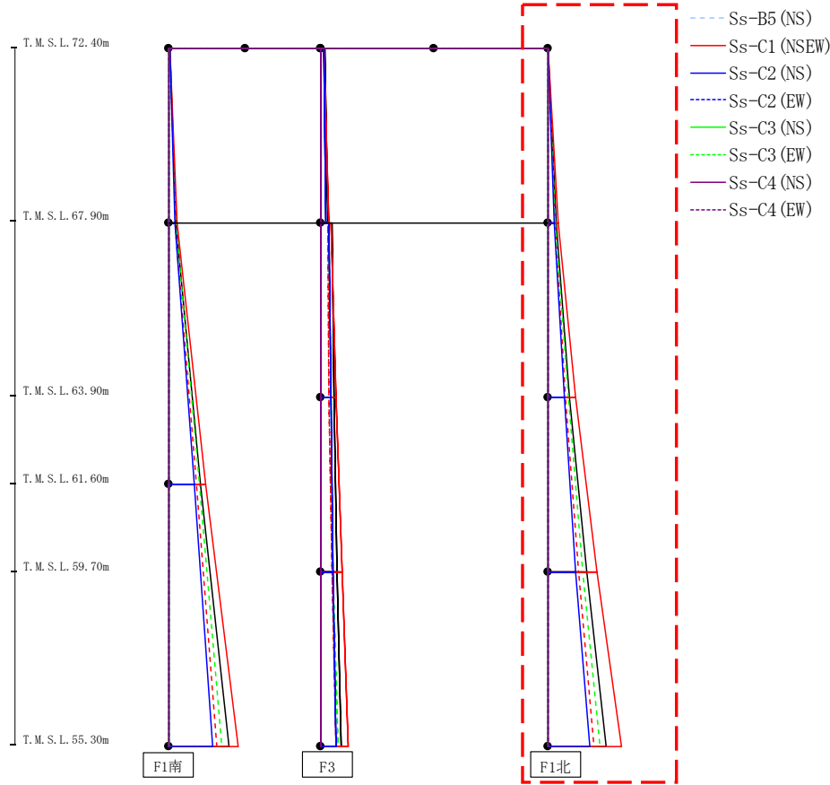
第4.2.2-15図 支持架構の最大応答曲げモーメント(G10B防護ネット架構, +1σ地盤, NS断面②) (3/3)
