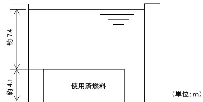
第 3.4-2 図 燃料有効長頂部から水面までの水位
