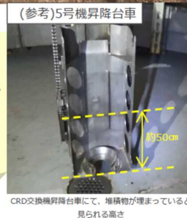
(参考)5号機昇降台車 CRD交換機昇降台車にて、堆積物が埋まっていると見られる高さ
