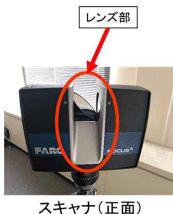
図4 3Dレーザースキャナのレンズ部
