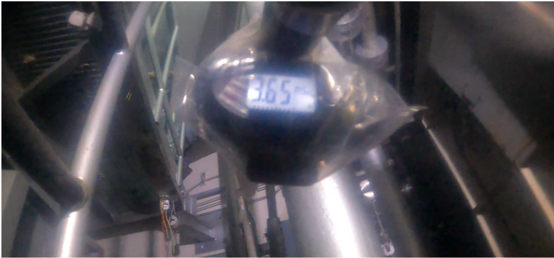
図 15 測定対象配管周辺の線量率
