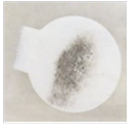
図5 2号機原子炉建屋内で採取したスミヤ試料の写真（左）とイメージングプレート分析結果（右）の例（5階壁面試料）
