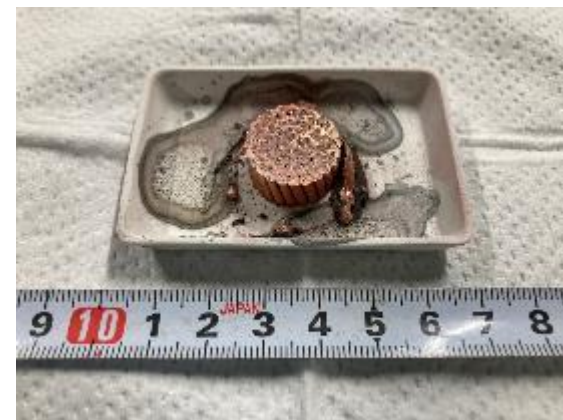
試験後 (1000°C水蒸気環境下)
