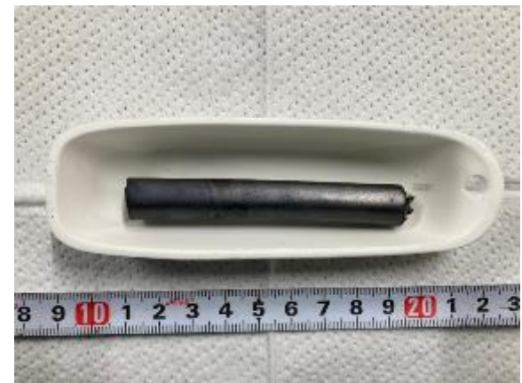
試験後 (200°C水蒸気環境下)
