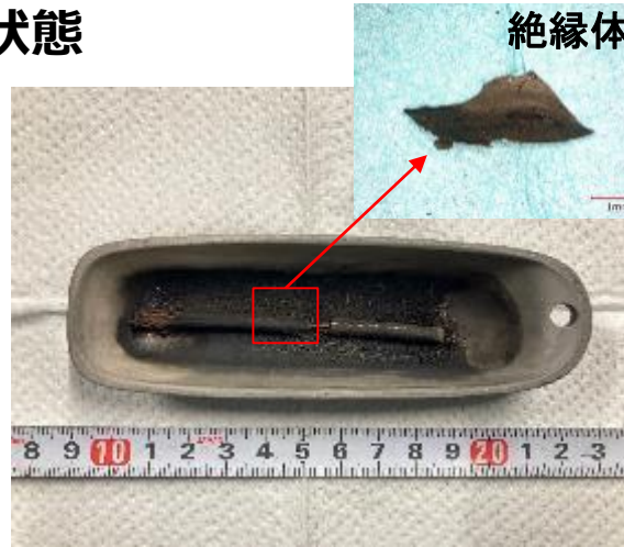
試験後 (1000°C水素ガス環境下)
