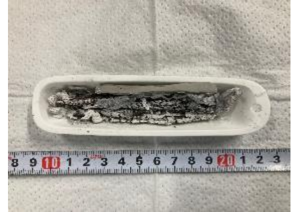
試験後 (1000°C水蒸気環境下)
