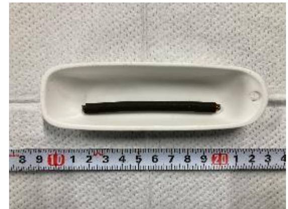
試験後 (200°C水蒸気環境下)
