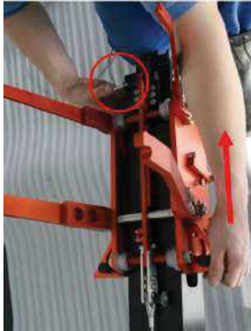
図 2.9.20 安全ピン (P2) の挿入
