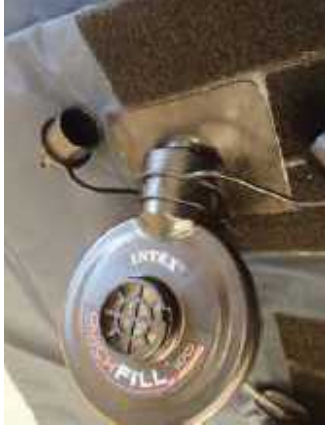
図 2.8.3 エアバッグの膨張ポートに空気ポンプのスバウトを挿入
