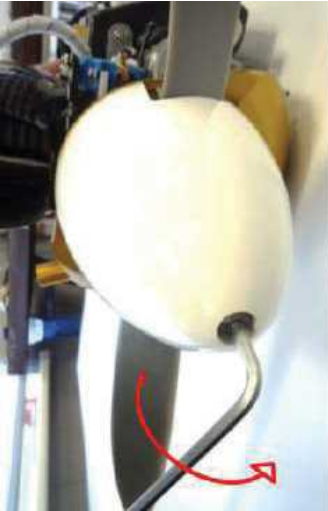
図 12.1 スピナーの取り外し
