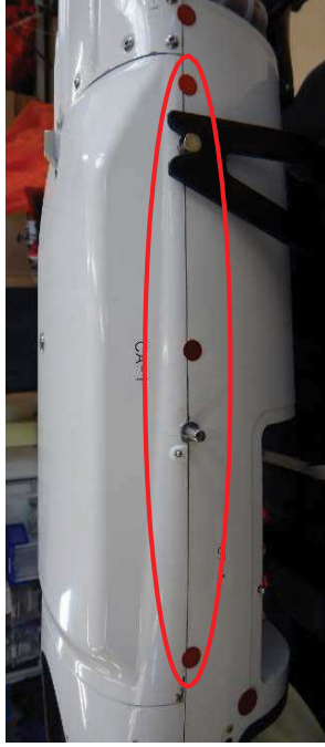
図 2.2.2 エアバッグカバー用ブッシュ金具およびエアバッグカバーピン
