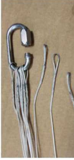
図 2.7.5 レーピッドリングからサスペンション紐を取り外す
