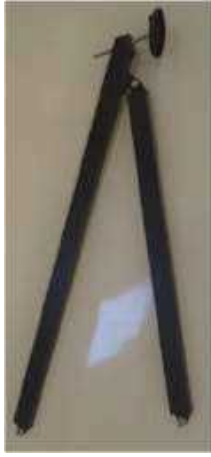
図 2.10.4 組み立てられたアンテナサポートレッグ
