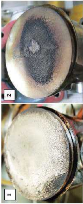
図 2.5.33 ピストン上部のデポジットの層が許容範囲外(1)の場合と許容範囲(2)の場合
