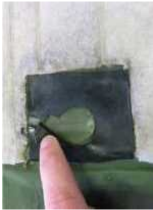
図 2.8.1 エアバッグの膨張ポートの損傷
