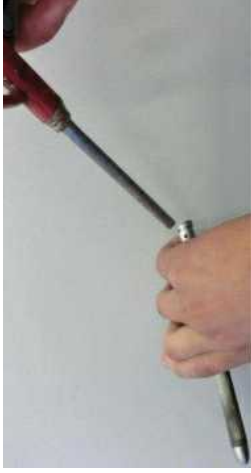
図 2.4.10 圧縮空気でピトー管をクリーニング
