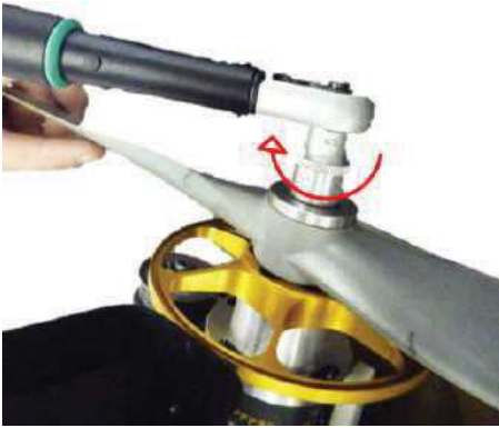
図 12.5 プロペラナットの固定
