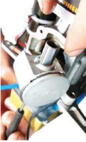
図 2.5.35 ピストンピンをピストンのボアから押し出す
