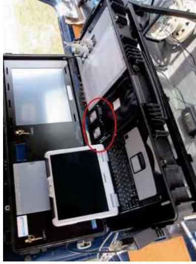
図 2.11.1 バッテリーの取り付け
