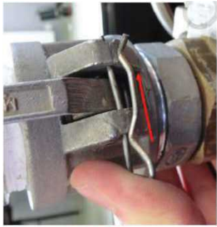
図 2.9.29 空気圧ジョイントに安全ピンを挿入
