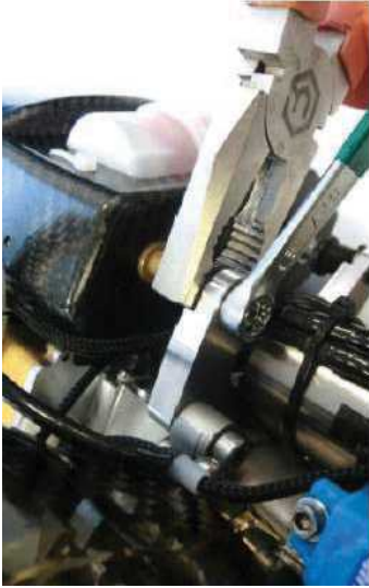
図 8.3 エンジン取り付けナットを外す
