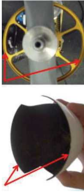
図 12.6 スピナーとスピナーバックプレートの接合面
