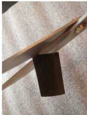
図 5.3 リップストップ生地 of 粘着テープをパッチ状に切断
