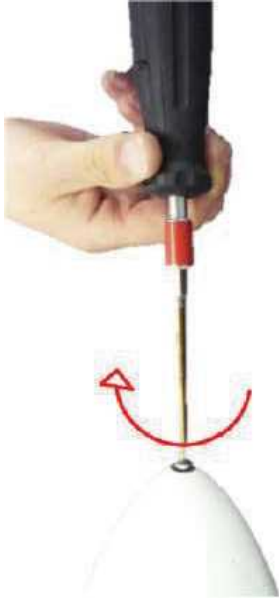
図 12.8 スピナー用ネジの締め付け
