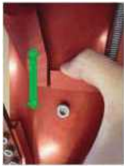
図 2.9.34 キャリッジのロックングアームが自由に動くか確認
