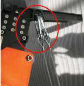
図 2.9.25 カタパルトのリアレッグに繋がったアンカーケーブル
