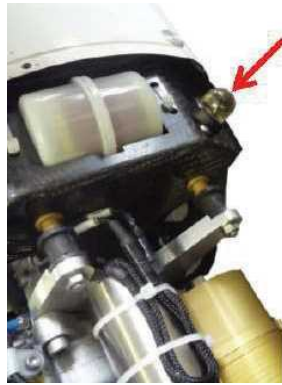
図 11.1 燃料ポンププライマーのバルブを押し
