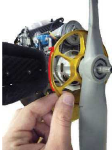
図 12.4 プロペラに対するクラウンシャフトの位置の調整
