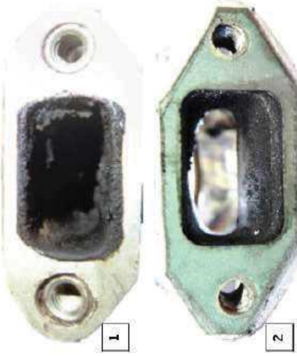
図 2.5.32 シリンダーの排気管のカーボン・デポジットが許容範囲外(1)の場合と許容範囲(2)の場合
