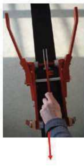
図 2.9.16 レールが正しく組み立てられたか確認するためにキャリアッジを押し下げる
