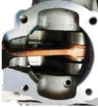
図 2.5.36 クランクケースのクリーニング
