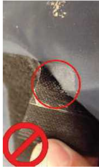
図 2.8.5 エアバッグのマジックテープが剥れた状態
