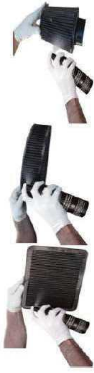
図 2.5.14 エアフィルターに K&N 製クリーナーを吹きかける
