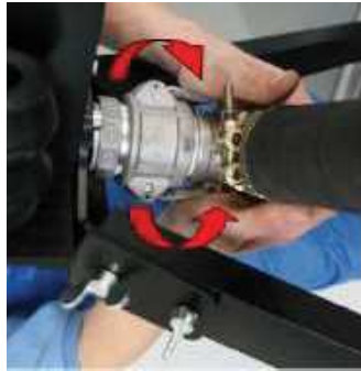
図 2.9.27 空気圧ホースをカタハルトに接続
