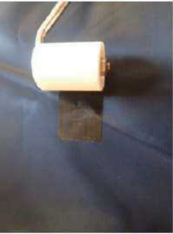
図 5.6 ローラーでパッチに圧をかける
