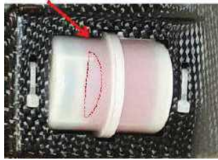
図 11.5 燃料で満たされた精密燃料フィルター(矢印は必要な燃料レベルを示す)
