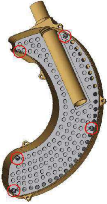
図 2.5.26 サイレントマフラーの穴付きウォールの取り付けネジ
