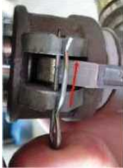
図 2.9.28 空気圧ジョイントに安全ピンを挿入
