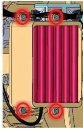
図 2.5.13 エンジンからエアフィルターを外します
