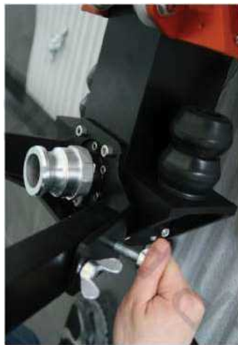
図 2.9.10 カタパルトのフロントレグ(C)の接続
