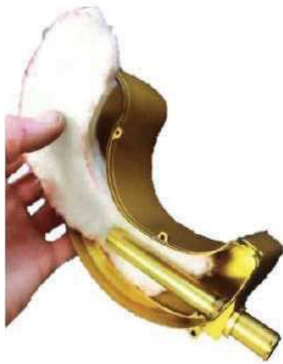
図 2.5.29 マフラーのボディに緩衝材を挿入
