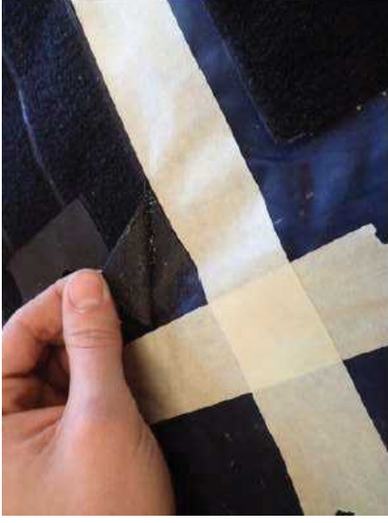
図 5.8 接着エリアのマスキング
