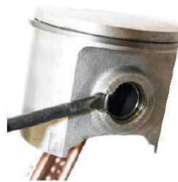
図 2.5.34 ピストンピンのスナップリングを外す
