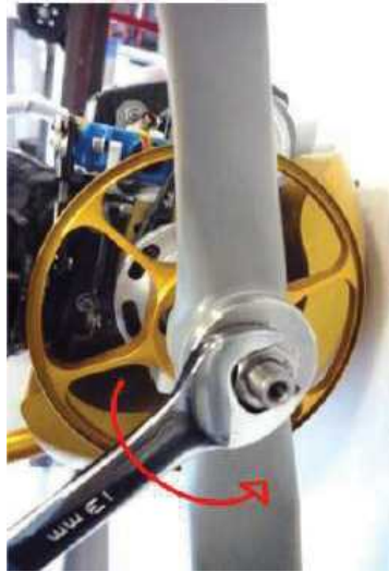
図 12.2 プロペラナットの取り外し
