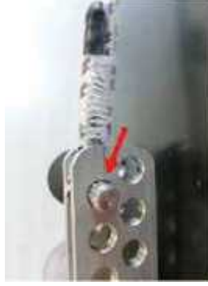
図 2.9.22 ロープの弛みをなくすため、隣の穴に挿入されたピン (P1)
