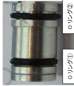
図 2.4.8 Oリングの点検
