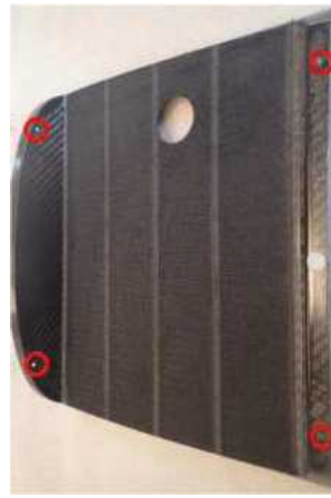
図 2.2.9 アビオニクス/インペラーカバーのネジ穴の点検
