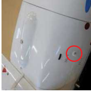
図 2.2.4 パラシュートカバーのピンホールの点検
