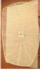
図 2.10.10 組み立てられたリフレクター
