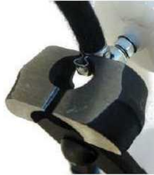
図 7.2 燃料ホースクリップの取り付け
