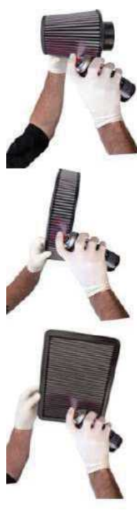
図 2.5.16 エアフィルターにオイルを吹きかける
