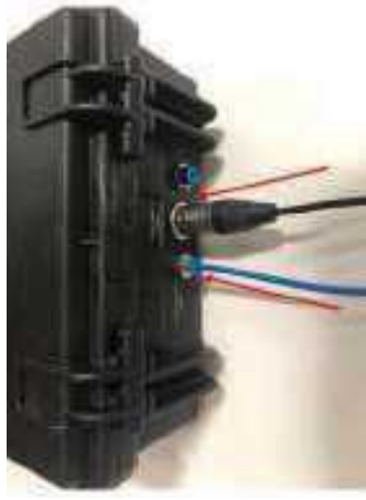
図 2.9.30 コントロールワイヤーをコントロールボックスに接続
