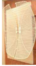
図 2.10.9 リフレクター部品の上部のペアと下部のペアの組み立て
