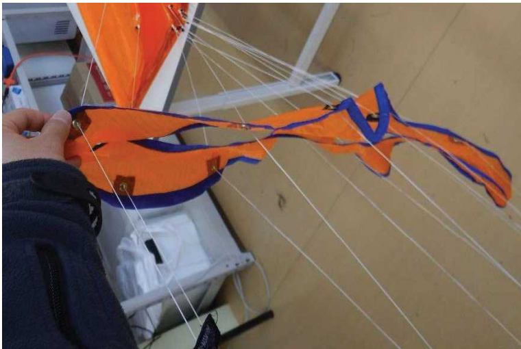
図 2.7.4 スライダーの点検
