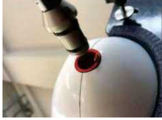
図4.4.3 ビトー管の位置合わせ箇所
