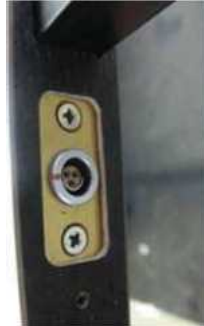
図 4.11.5 ブッシュブルー型ファイッシャーコネクタコンセント
