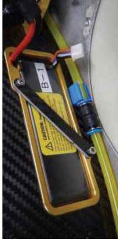
図 4.5.3 固定されたバッテリー
