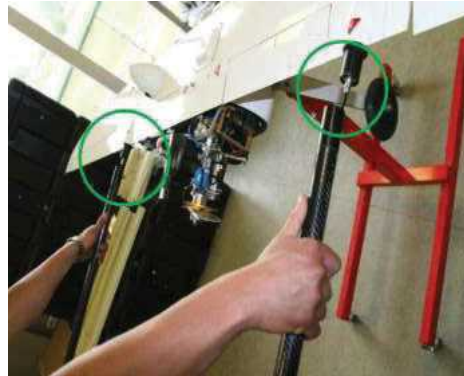
図 4.12.6 テールブームの中央翼への接合
