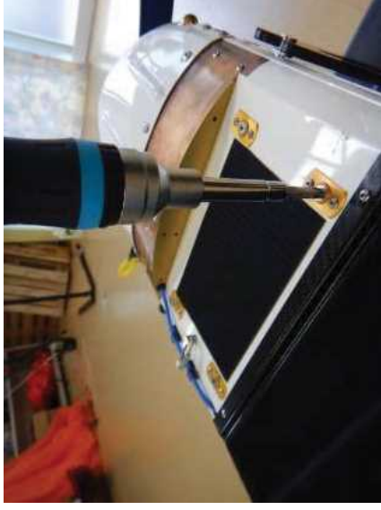
図 4.7.1 エンジン取り付けボルトの固定
