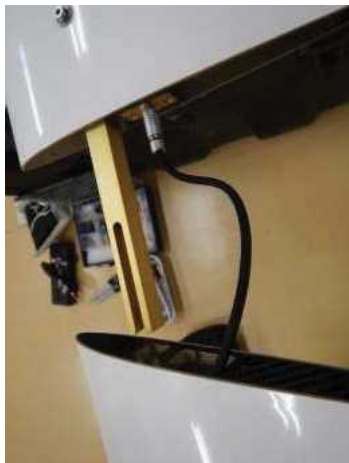
図 4.11.6 ファイジヤープラグがコンセントに正しく設置された状態
