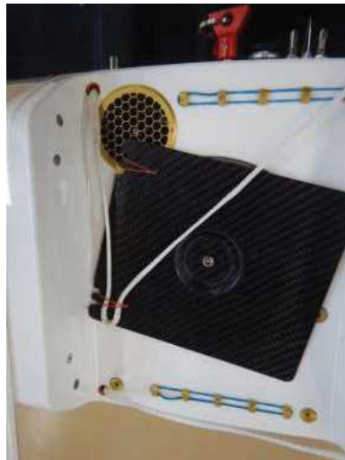
図 4.8.26 右側のライザー紐の固定
