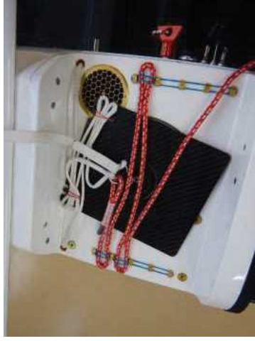
図 4.8.30 ブライドルを固定バンドに収納する様子
