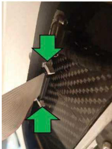
図 4.10.3 IDC コネクタのレバーのロック
