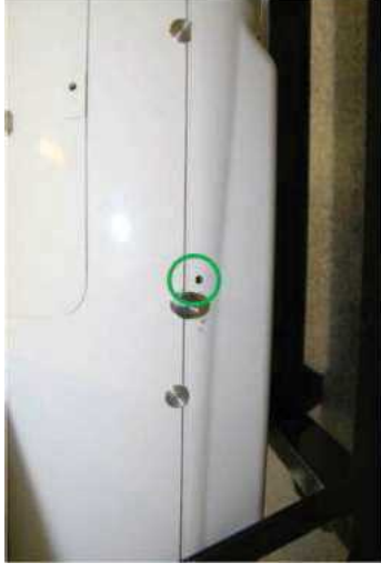
図 7.7.2 エアバッグカバーの安全ピンが胴体に引き込まれた状態
