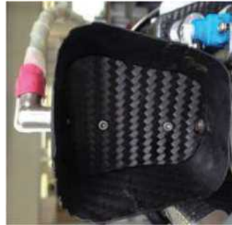
図 7.5.6 ダクトフラップが「Closed」の状態
