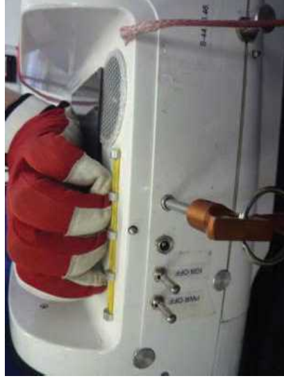
図 4.8.3 パラシュートセーフティピンの挿入
