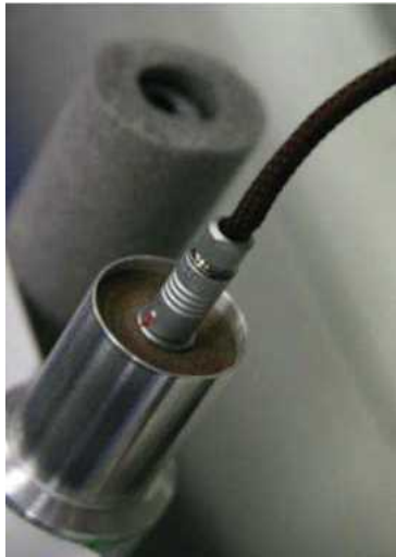
図 4.12.5 中央翼に取り付けられたプッシュプル型フィッシャーコネクタ
