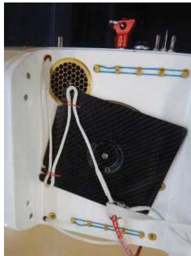
図 4.8.27 左側のライザー紐の固定
