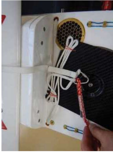
図 4.8.28 後方のライザーをハラシューベイに置いた状態
