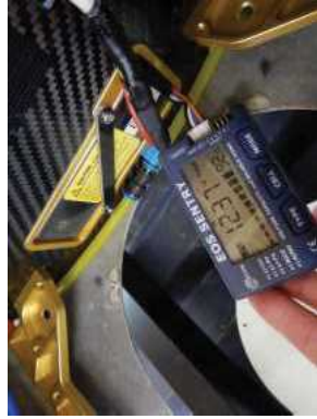
図 4.5.5 バッテリー電圧チェック
