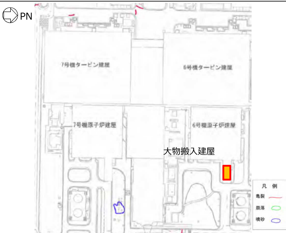
図20 中越沖地震後の亀裂・噴砂分布図※
