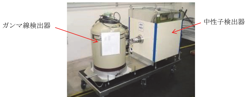
写真 1.1-2 AVIS の外観写真
