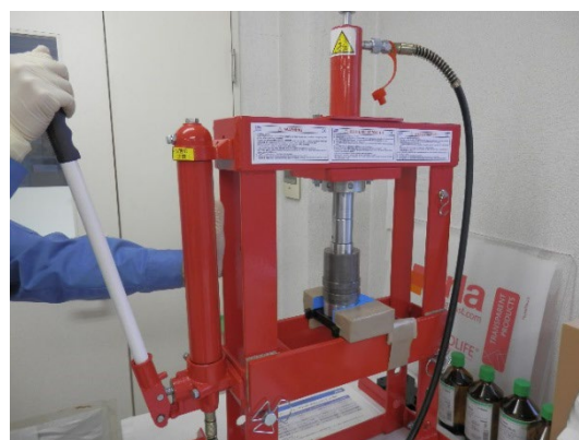
図 2-2-9 測定試料成型用のプレス機
