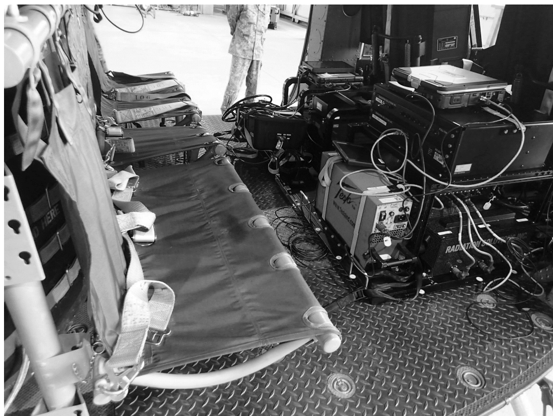
Fig. 5-3 航空機モニタリングシステムの搭載状況
