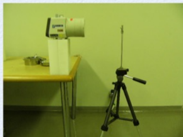
線源をスタンドに設置
