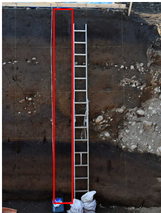
図 2.2.30 出ノロトレンチでの連続サンプリング① 西側法面 測線 8.3m位置
