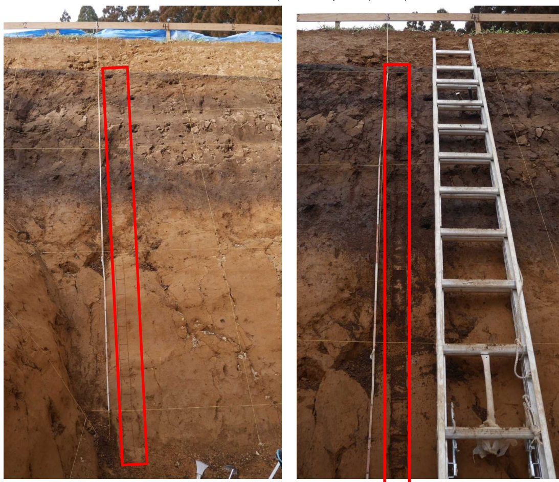
図 2.2.58 深度 3m 以深(右)および深度 3m 以浅(左)の連続サンプリング状況
