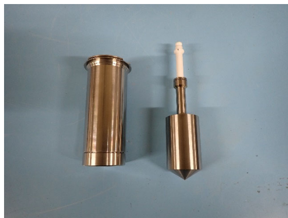
写真-4.8 二重円筒型粘度計による底質模型の粘性確認
