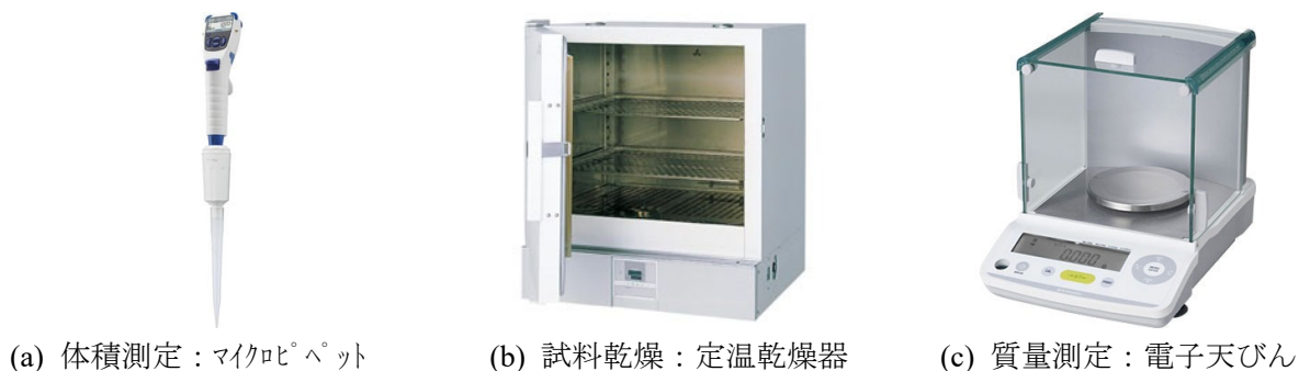
写真- 4.7 巻き上がった底質濃度の計測機器
