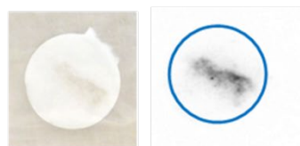
図 3.1.1.3(3)-1 2号機原子炉建屋内のスミヤ試料の写真およびIP画像
