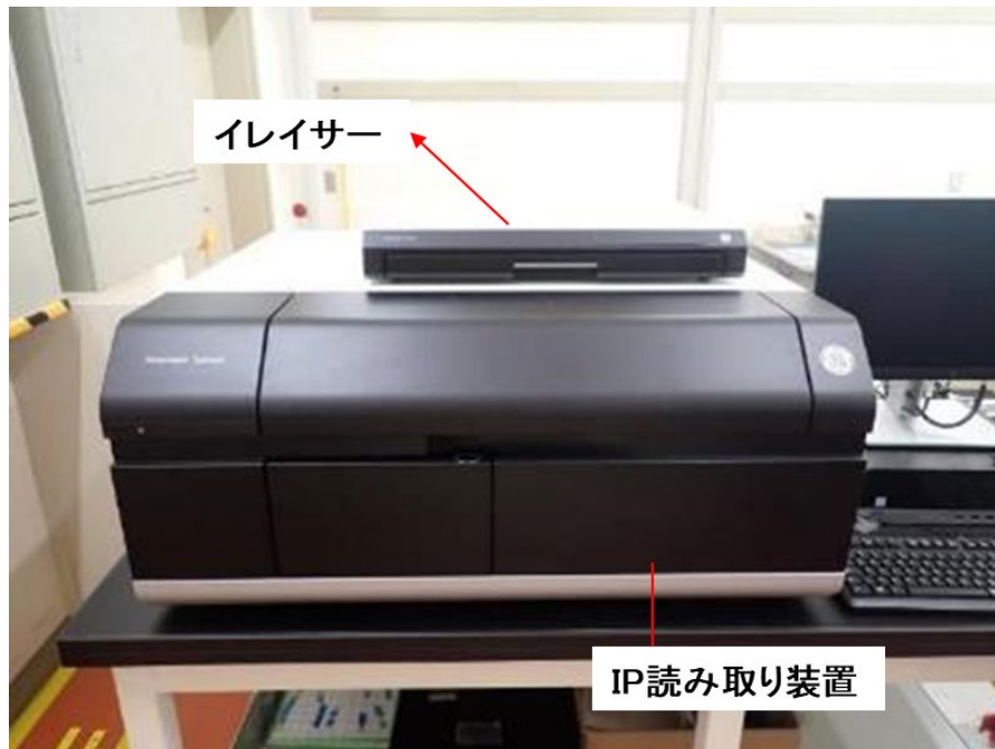
図 2.1.4-2 イメージングプレート (IP) 読み取り装置およびイレイサーの概観
