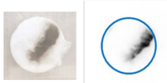
図 3.1.1.3(3)-1 2号機原子炉建屋内のスミヤ試料の写真およびIP画像
