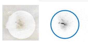
図 3.1.1.3(3)-1 2号機原子炉建屋内のスミヤ試料の写真およびIP画像
