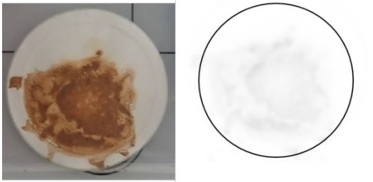
図 3.1.1.3(7)-3 U12SGS-6, U3SGF-B1-1-2, U3SGF-B6-1-2 の酸分解後ろ過残渣の IP 結果
