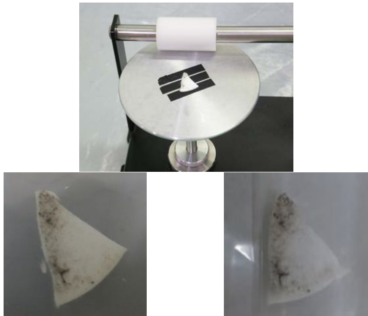
図 3.1.1.3(8)-1 SEM 観察用ステージの装着様子（上段） 及び SEM-EDS 測定前後のスミヤ試料の外観（下段）
