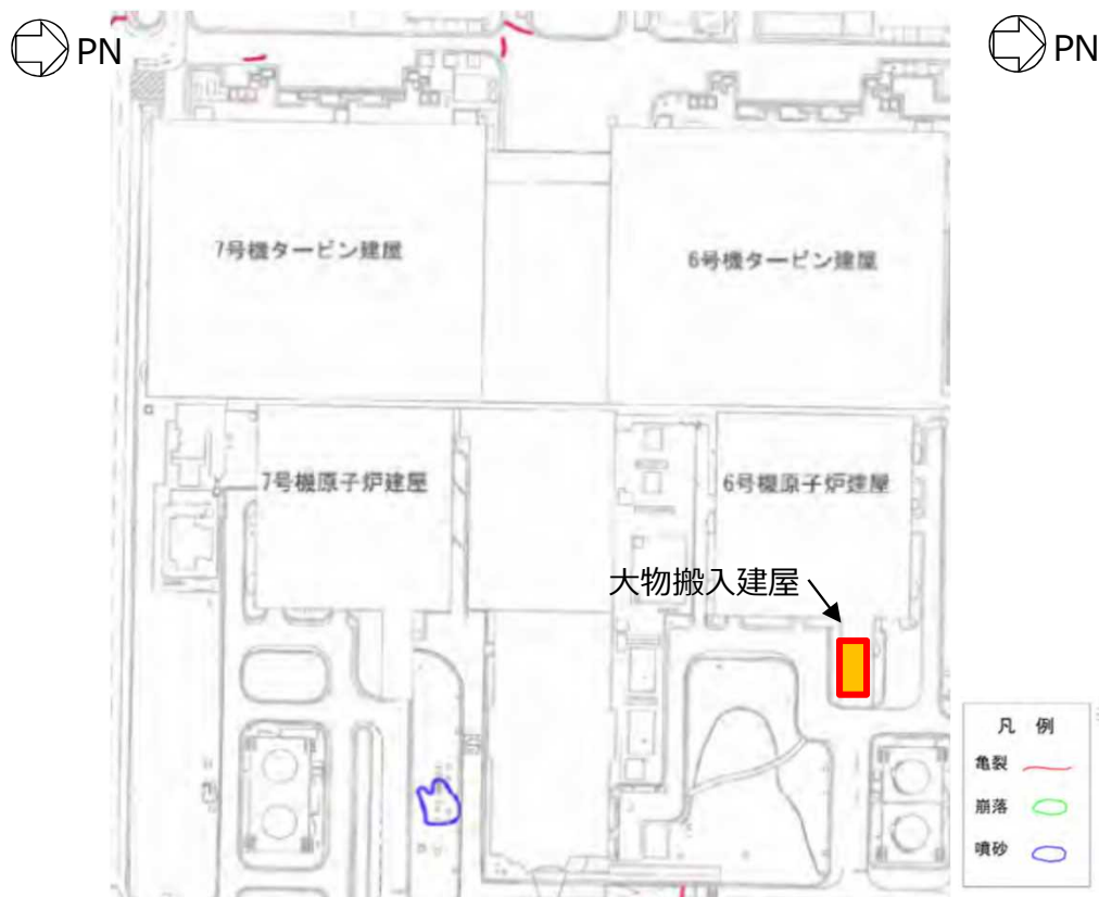
図19 中越沖地震後の亀裂・噴砂分布図※
