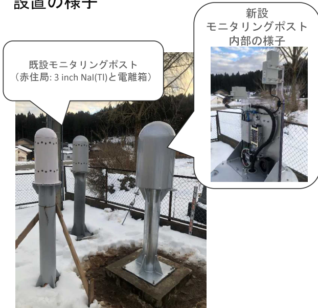
石川県導入の高線量率用検出器で試験 既設モニタリングポストに隣接して設置
