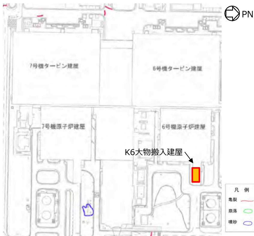
図19 中越沖地震後の亀裂・噴砂分布図
