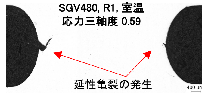
切欠付平板試験片の断面観察結果
