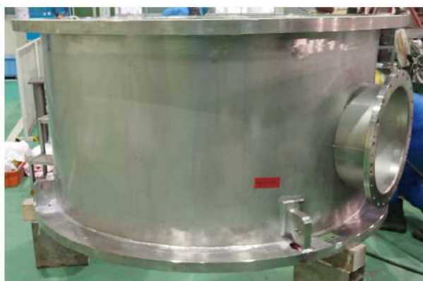
図 2.1.3.1 製作中の STACY 炉心タンク (上下 2 分割)
