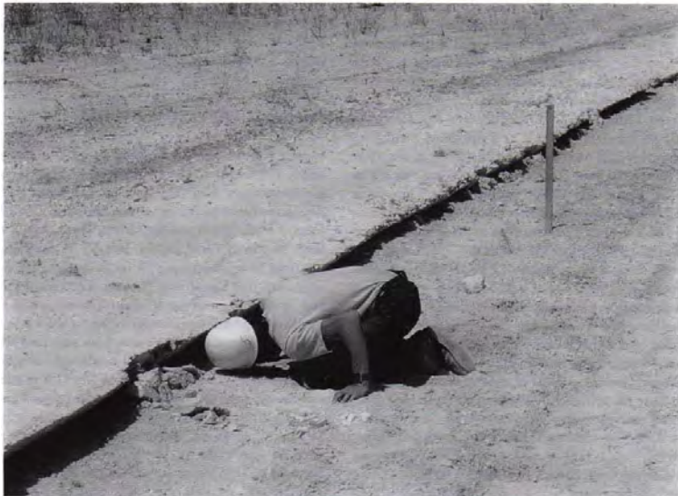
図2 1981年の掘削面底盤での南傾斜の逆断層変位(西南西方向を撮影)
