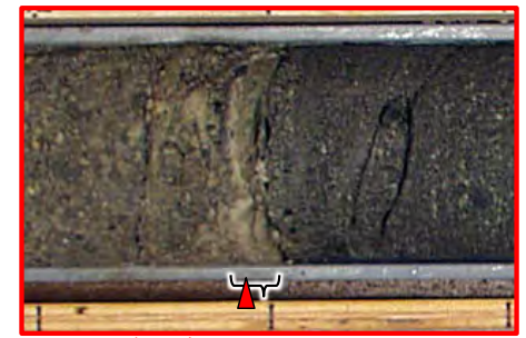
シームS-11 9.18m~9.19m: 細粒凝灰岩が分布する。
