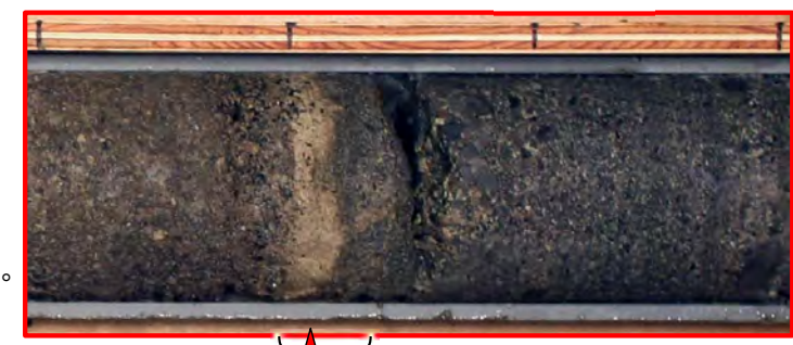
シームS-11 4.71m~4.73m: 細粒凝灰岩が分布する。
