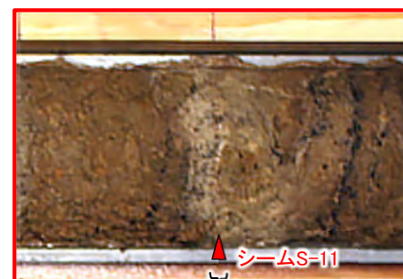
3.80m~3.81m: 細粒凝灰岩が分布する。
