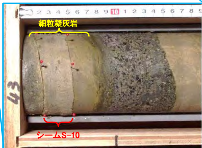
シーム付近のコア接写写真
