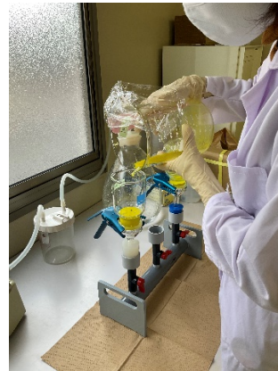
放射性セシウム分析の際のリンモリブ デン酸アンモニウム(黄色粉末)のろ別
