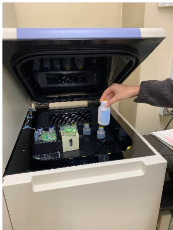
トリチウムを定量するため、液体シ ンチレーションカウンタに測定用試 料を投入する様子
