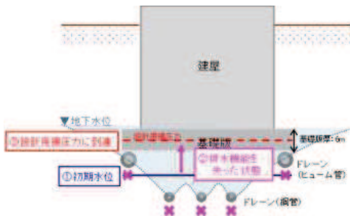
(b) 地盤中の地下水の挙動 (概念図)
