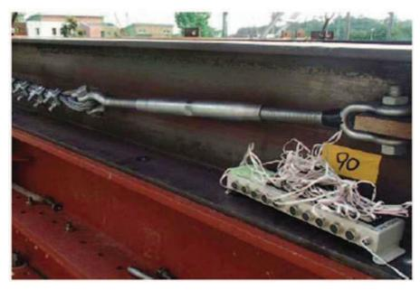
図 2-1 ひずみゲージ付きターンバックルの設置状況
