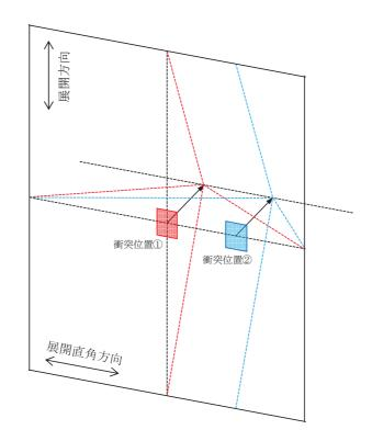
図 3-1 展開直角方向オフセット衝突位置図
