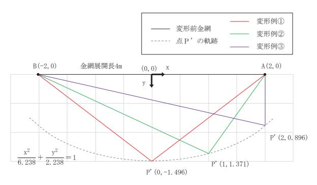
図 2-1 展開方向の金網交点列 1 列の衝突点 P'の軌跡
