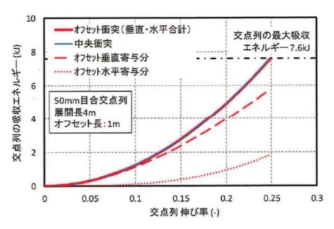
図 2-4 展開方向オフセット衝突と中央衝突のエネルギ比較
