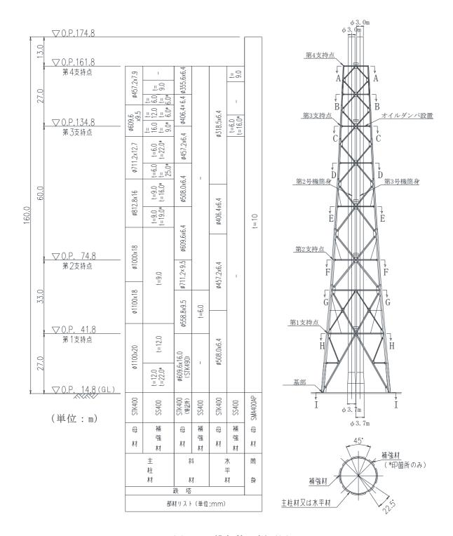
図 2-1 排気筒の概要図
