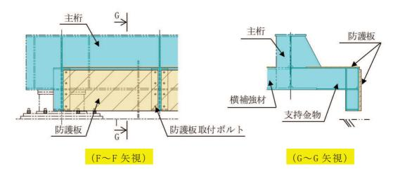
図 2-1 防護板概要図(2/2)
