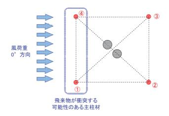
図 3-2(1) 飛来物が衝突する可能性のある部材(0°方向)
