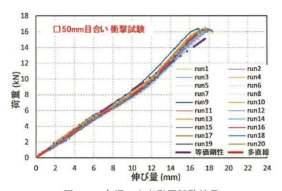
図 2-1 金網の交点引張試験結果
