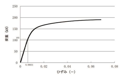
図 3-2 ワイヤロープ引張試験結果
