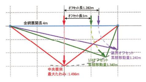
図 2-5 各衝突位置の 50mm 目合交点最終変形図
