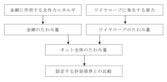
図 3-2 たわみ評価の評価フロー
