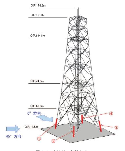
図 3-1 主柱材の部材名称
