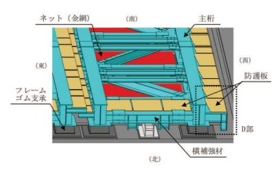
図 2-1 防護板概要図(1/2)
