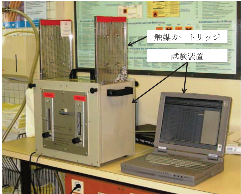
図 4-1 検査装置概要図
