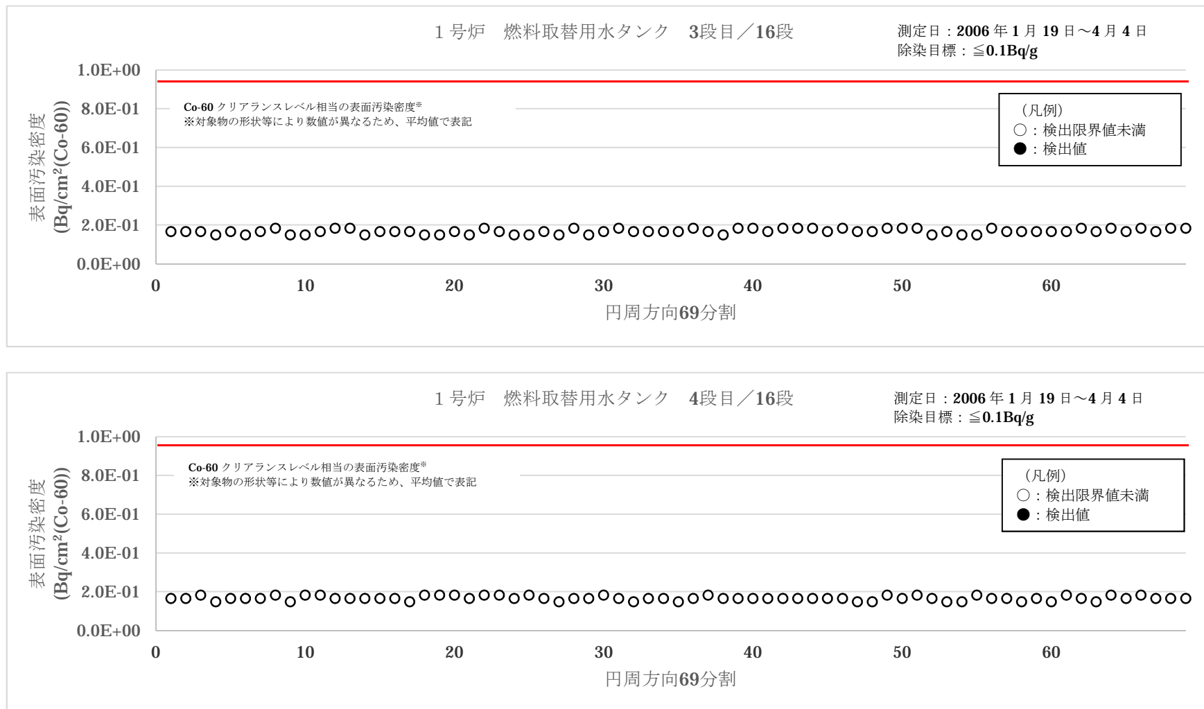
図3 大飯1号炉 燃料取替用水タンク表面汚染密度測定結果 (2/8)
