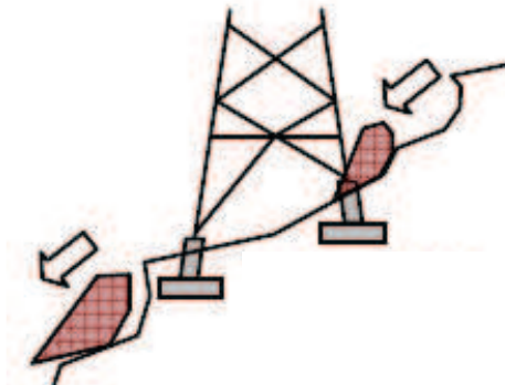
【急傾斜地の崩壊】
