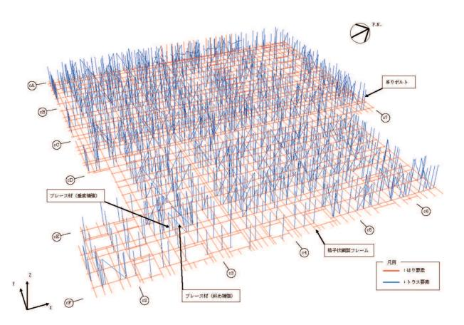
図 4-1 天井照明上部の解析モデル
