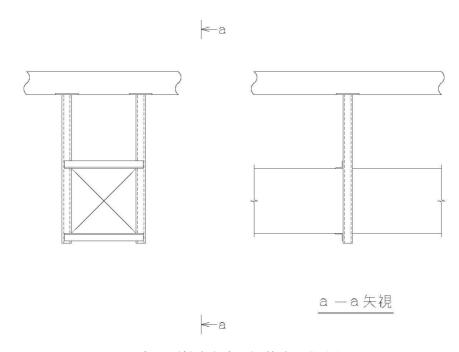
図 7-1 2 方向(軸直角方向)拘束の代表例
