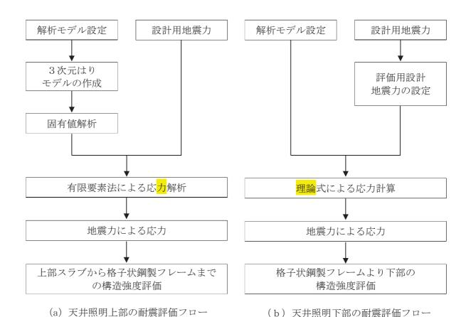
図 2-2 中央制御室天井照明の耐震評価フロー
