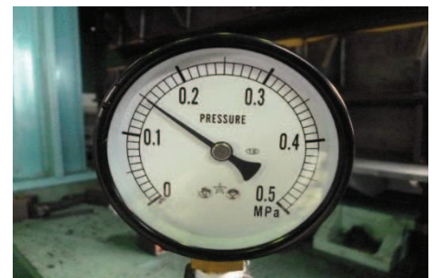
加圧完了 (0.15 MPa, 1 時間保持後, 漏水なし)
