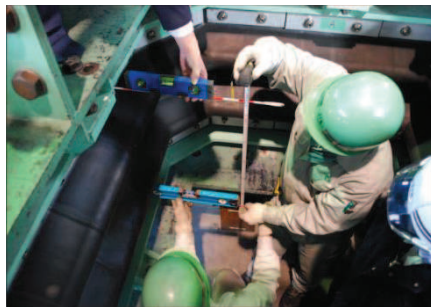
伸び変形量 (枠間距離) 計測状況 (計測値 570mm - 初期値 370 mm * = 伸び 200mm)
