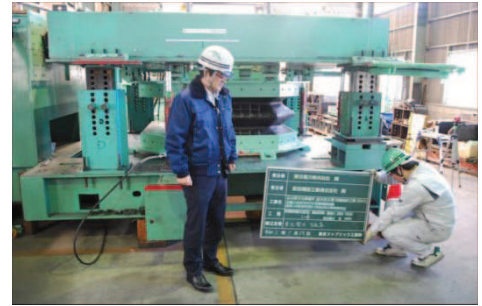
伸び変形後状況
