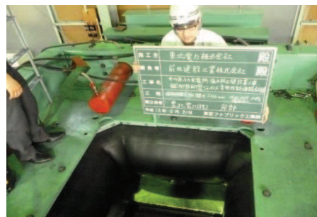
加圧完了 (0.15 MPa, 1 時間保持後, 漏水なし)
