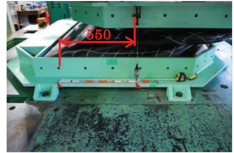
せん断変形後状況 (せん断 550mm)
