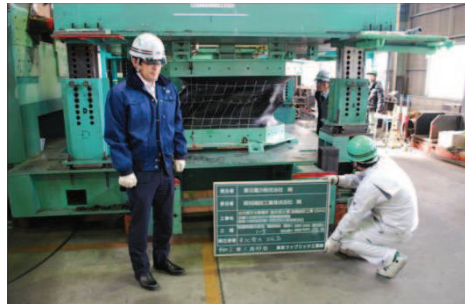
伸び+せん断変形後状況 (伸び 350mm, せん断 200mm)
