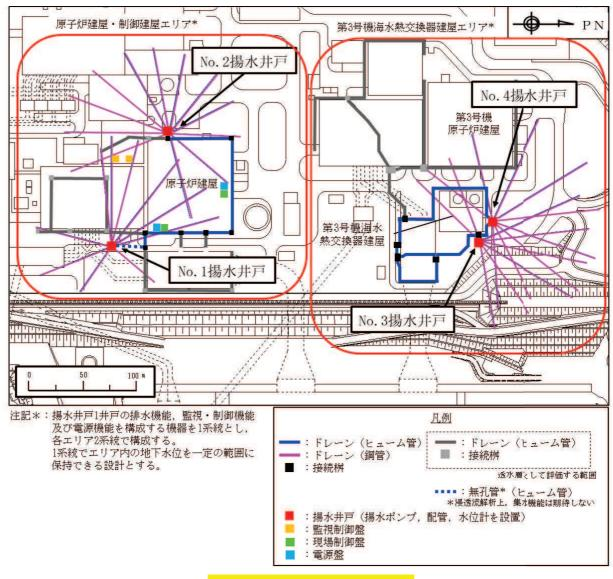
図 4-1 地下水位低下設備の構成
