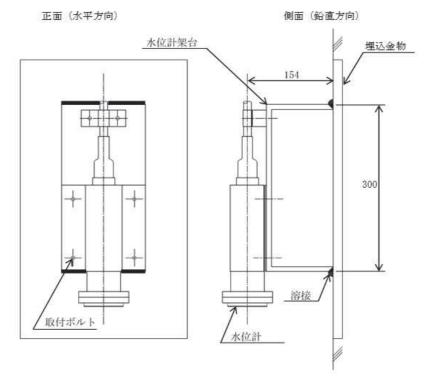
図 4-11 水位計の構造図
