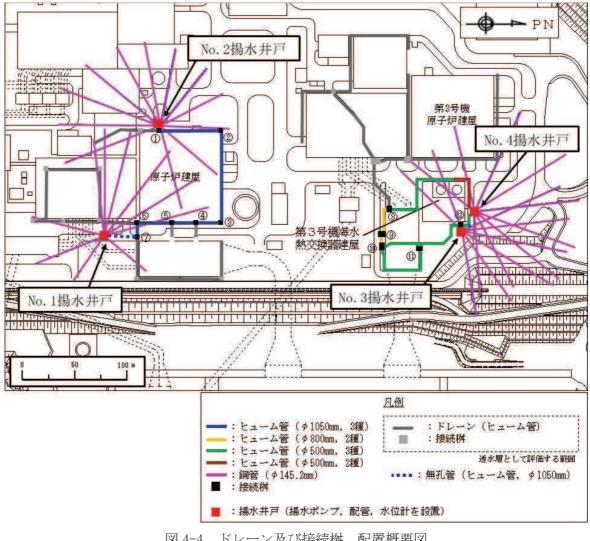
図 4-4 ドレーン及び接続桝 配置概要図
