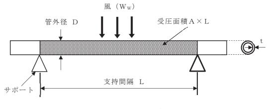
図 3-3 配管モデル図
