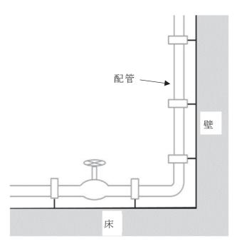
図 3-2 配管及び弁の構造強度評価の評価対象部位
