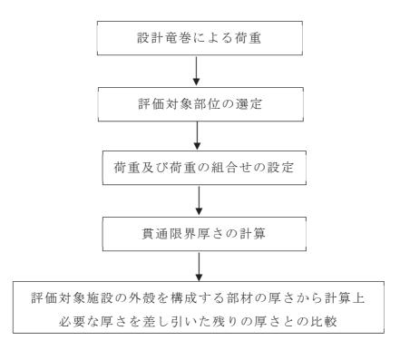
図2-5 配管及び弁の衝突評価フロー
