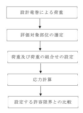
図2-6 配管及び弁の構造強度評価フロー
