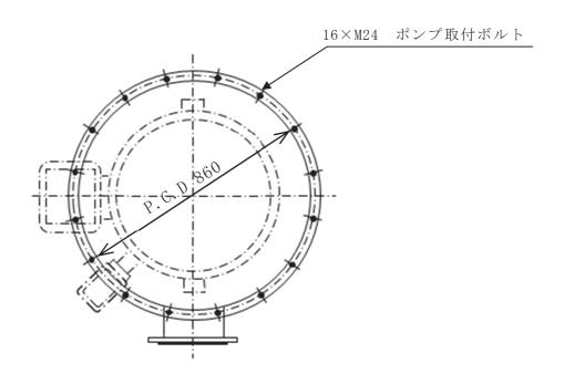
図 3-9 ポンプ取付ボルトの配置図
