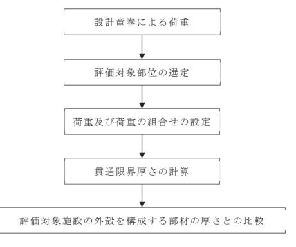
図 2-3 高圧炉心スプレイ補機冷却海水ポンプの衝突評価フロー
