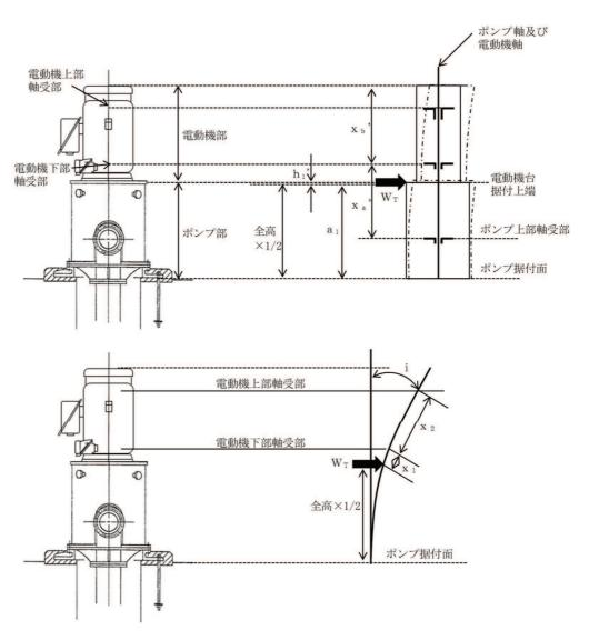
図 3-7 高圧炉心スプレイ補機冷却海水ポンプのたわみ量計算モデル図
