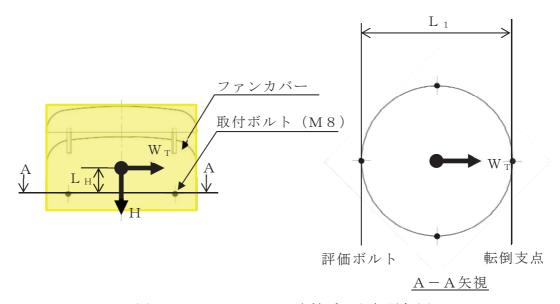
図 3-13 ファンカバー取付ボルト部詳細図
