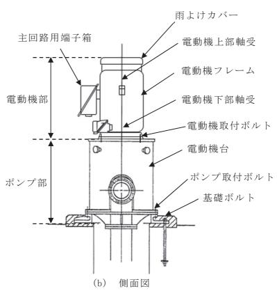
図 2-2 高圧炉心スプレイ補機冷却海水ポンプの概要図
