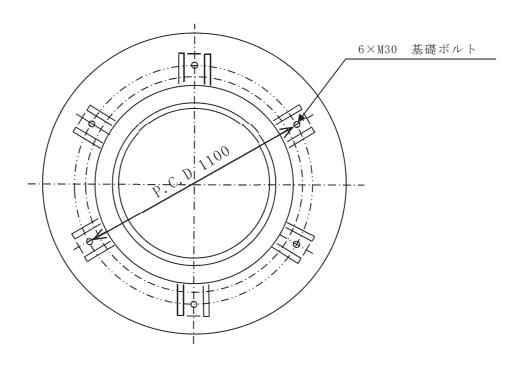
図 3-10 基礎ボルトの配置図
