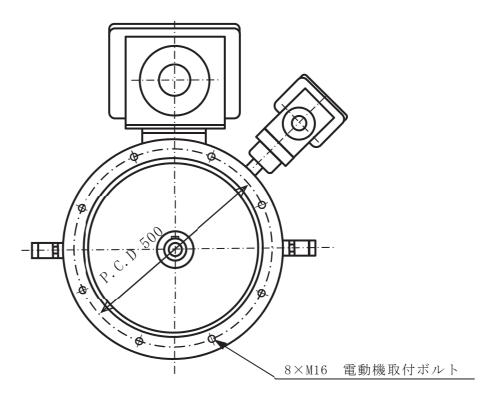
図 3-8 電動機取付ボルトの配置図
