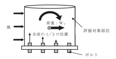
図 3-5 応力の計算モデル図 (ポンプ部)
