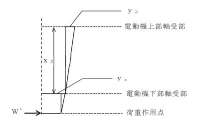
図3-17 電動機上部軸受部のたわみ量と傾斜計算モデル図
