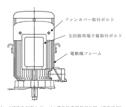
図 3-3 高圧炉心スプレイ補機冷却海水ポンプの構造強度評価部位図 (電動機部)
