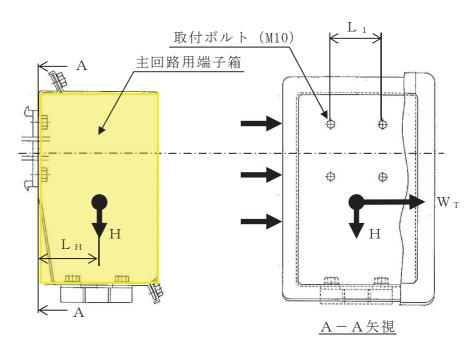
図 3-12 主回路用端子箱ボルト部詳細図
