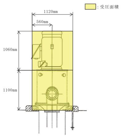
図 3-14 風による水平荷重の受圧面積
