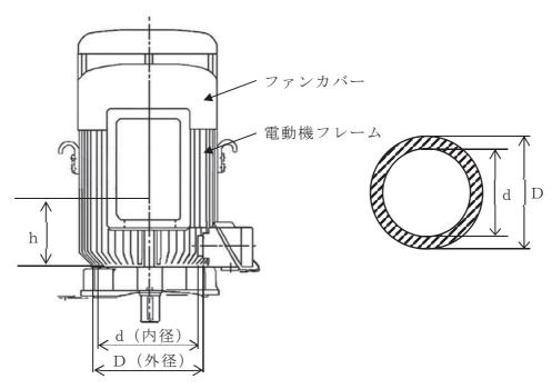
図 3-11 電動機フレーム詳細図
