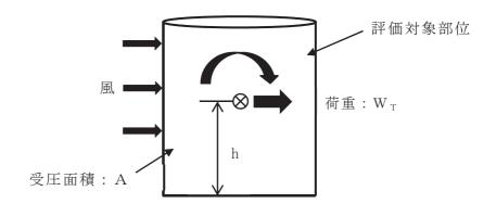
図 3-6 応力の計算モデル図 (電動機部)
