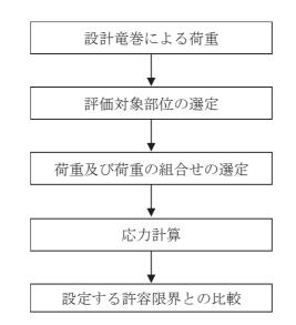
図 2-4 海水ポンプ室門型クレーンの強度評価フロー
