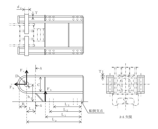
図 3-3 海水ポンプ室門型クレーン(エンドストッパ部拡大)のモデル図
