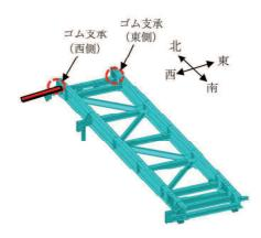
図 4 飛来物衝突位置及び評価対象(STEP2-2)
